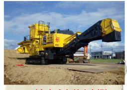
リテラ(自走式土質改良機) 現場で発生した低品質土をその場で目的に合った土質に改良し、 再利用します。
