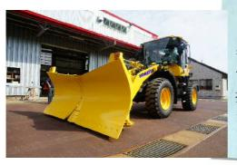
タイヤローダー 多くの容量物を すくって持ち上げたり 押したりと、パワフル な重機。写真は除雪 ドーザー仕様です。
